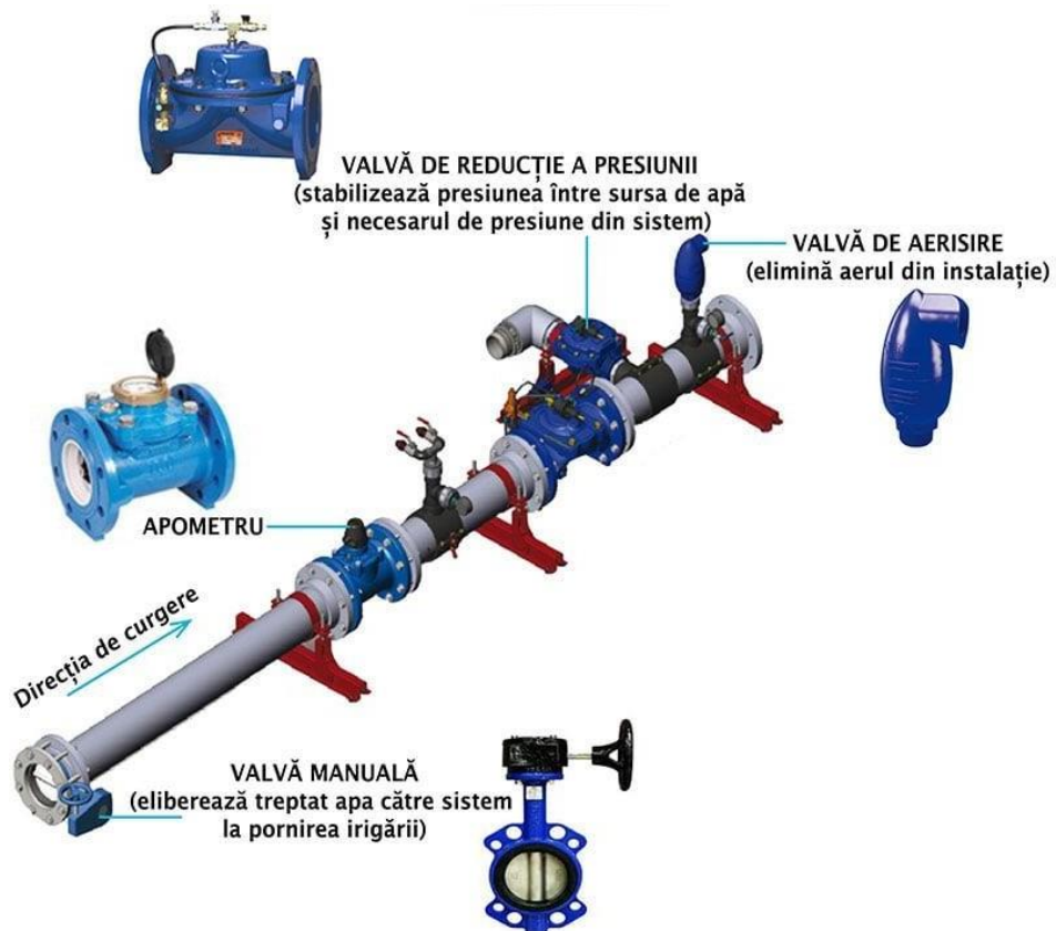
Figura 4.6. Componentă cap control principal (Netafim)
