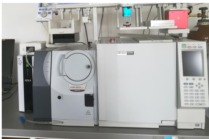
Figura 5.3: Sistem de gaz cromatografie Shimadzu 2010
