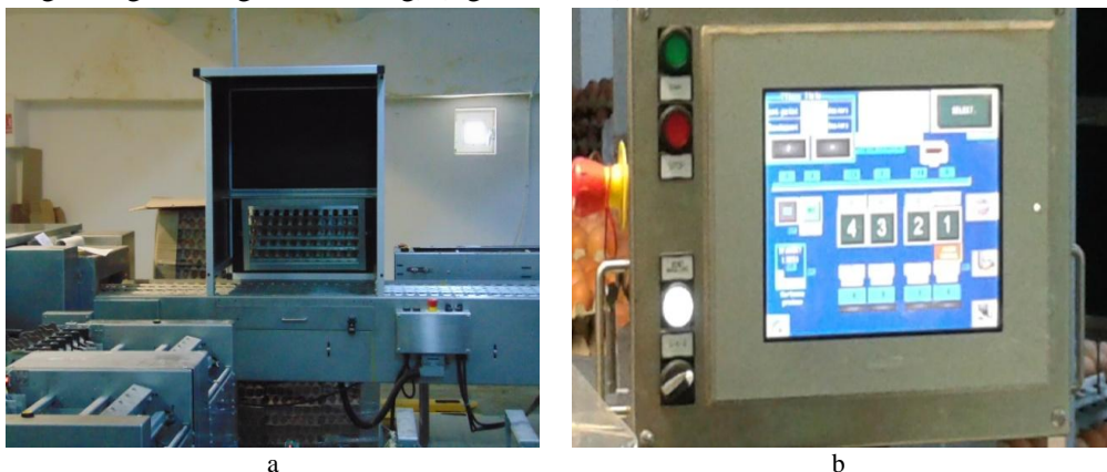
Fig. 6.14 Procesarea ouălor în stația de sortare-etapa a II-a (foto original) a-zona de ovoscopie; b-zona de cântărire
