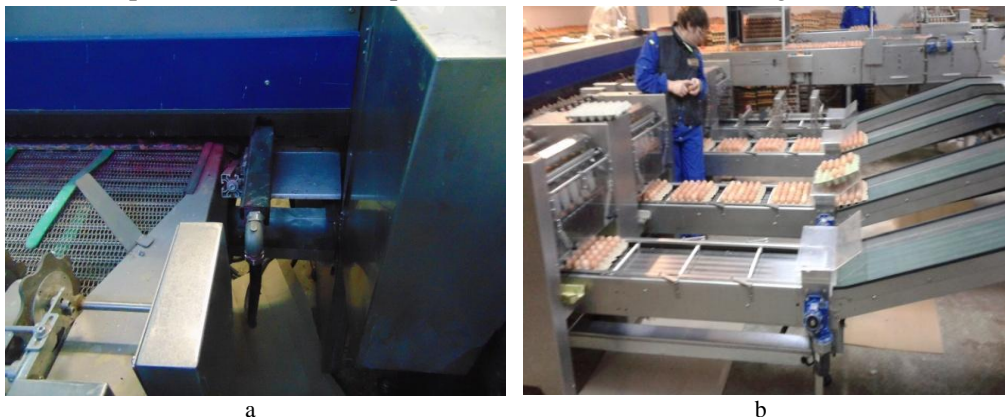
Fig. 6.15 Procesarea ouălor în stația de sortare-etapa a III-a (foto original) a-cap de imprimare cu jet; b-ambalarea și etichetarea ouălor Fig. 6.15 Egg processing in sorting station-stage III a-jet printing head; b-eggs' packing and labelling
